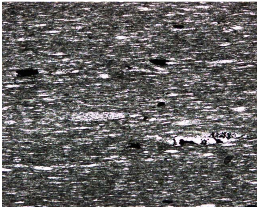
100-fache Vergrößerung, normal polarisiertes Licht. Dünnschliffaufnahme senkrecht zur Schieferung.
